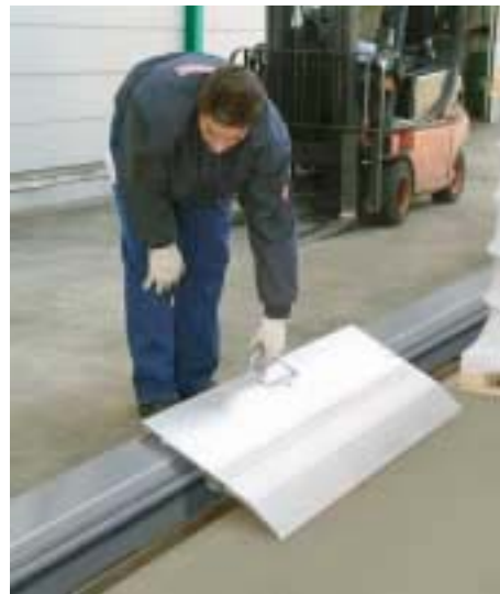
Spitze auf den Waggon auflegen und Anschlussprofil in die Schiene einlegen.
